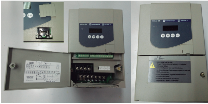
Figura 6.31 Variador Altivar 28, frontal, borneros de potencia y comandos y puerto de comunicaciones con conector RJ45.
