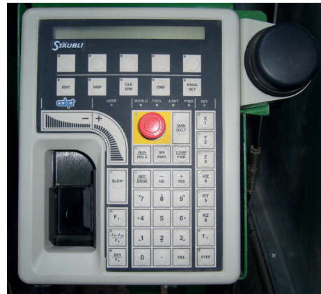
Figura 11.16 Teach pendant de un robot de pintura Stäubli RX Paint.
