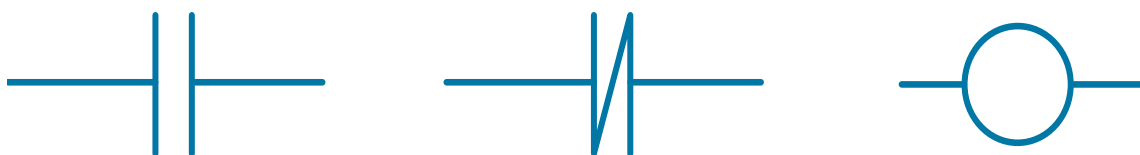
Figura 3.6 De izquierda a derecha: contacto NA del diagrama de contactos, contacto NC del diagrama de contactos y salida o bobina del diagrama de contactos.
