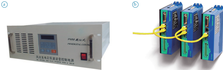
Figura 6.23 Inverter para conversión de continua a partir de paneles solares (a) y drivers para servomotores conectados mediante un cable de bus de campo (b).
