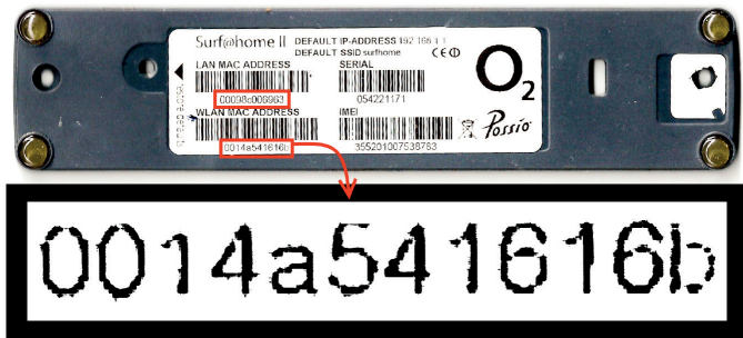
Figura 10.6 Etiqueta de un router UMTS-3G ( universal mobile telecommunications service ) con direcciones MAC para los módulos LAN y WLAN (wifi).
