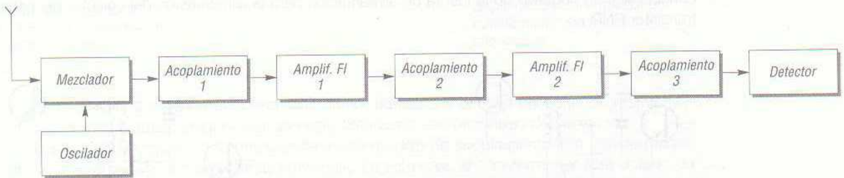
7.6 Esquema de bloques parcial de un receptor de radio superheterodino con dos etapas amplificadoras de FI.
