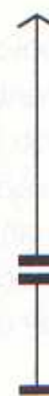
2.12 Un condensador en serie con la antena «acorta» la longitud de ésta.
