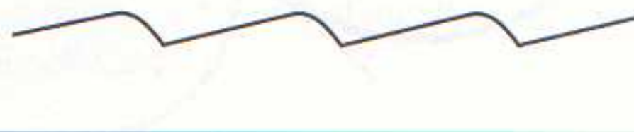
14.10 Al añadir el condensador, la tensión continua de salida se aplana por la descarga de éste.
