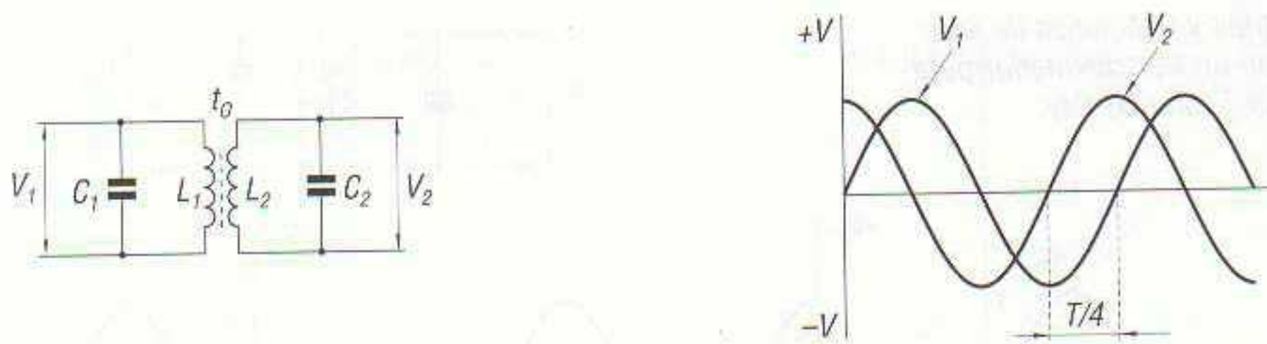
9.19 A la frecuencia de resonancia las tensiones en el primario y el secundario están desfasadas un cuarto de período.
